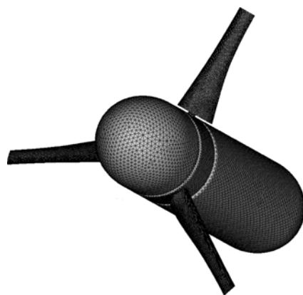
图 2 孤立螺旋桨外形和表面网格
